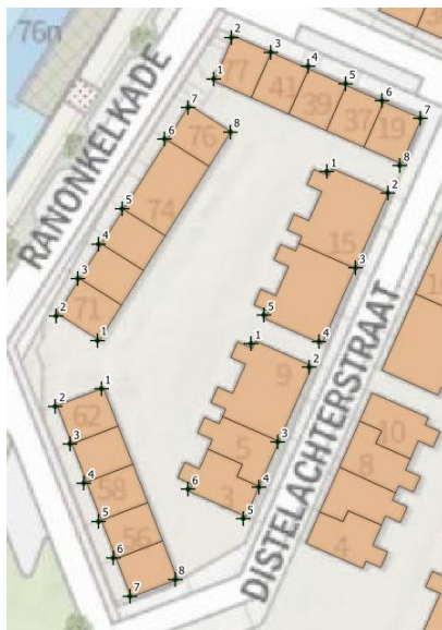
Figuur 6: Voorbeeld van te plaatsen meetboutjes in bouwmuren in Disteldorp.
