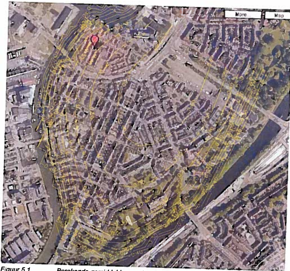
Figuur 5.1 Berekende gemiddelde grondwaterstand [m+NAP] in de toplaag Disteldorp e.o.
